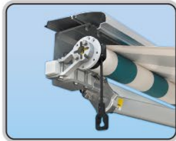
■電手動兼用モーター 停電などの非常時には、手で開閉操作ができます。 (ギア比 27:1 / 55:1)
